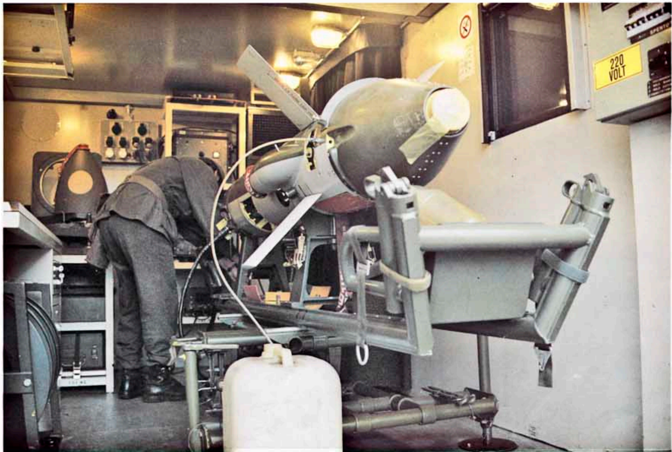
In apertura: lancio di un drone CL-89 della BAT. Il velivolo porterà a termine in meno di un'ora la missione di ricognizione. Sopra: il radiofaro utilizzato per la guida terminale di precisione del drone sull'area di recupero. Sotto: la BAT è dotata di una serie di laboratori ed officine campali che permettono l'immediata revisione e, se del caso, la riparazione dei droni.
